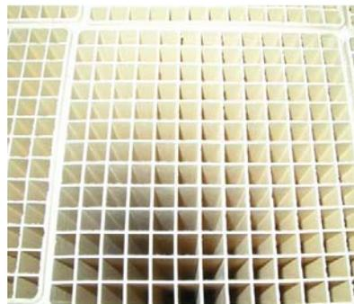
**Abbildung 1.67: Beispiel eines SCR-Katalysator-Moduls**
