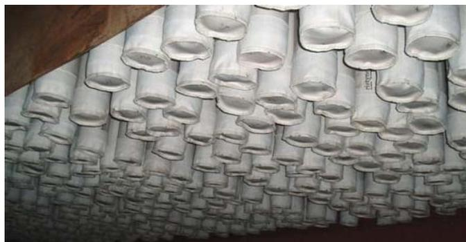
**Abbildung 1.60: Beispiel eines Gewebefilters und des Filtermaterials, das in einem Zementwerk im Vereinigten Königreich eingesetzt wird**
